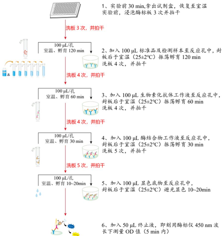
※特别说明: 振荡孵育转速控制在 100-300 r/min, 显色时间需要根据实际显色情况酌情缩短或延长, 但不可超过 30 min。当标准孔蓝色出现明显梯度时候 (标准孔前 4 孔蓝色明显, 后 4 孔蓝色不明显), 即可终止。
