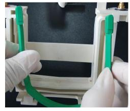
b. 将密封条旋转 180 度(正面朝里,反面朝外),重新装回电泳槽中,注意把密封圈周边压实,防止
